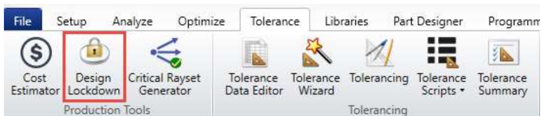
图 2.4.b. The Design Lockdown button in the Tolerance tab 公差菜单中的“锁定设计”按钮
